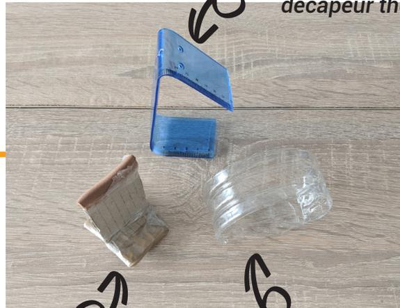
règle en plastique déformée avec un décapeur thermique
