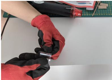
Quand le matériau est assez modulable, plier pour former un angle d'environ de 55°.
