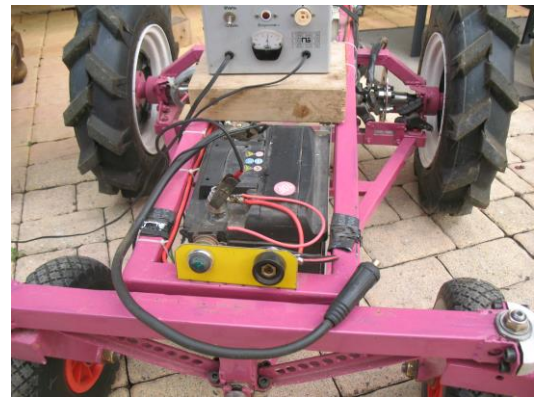
La base roulante avec sa connectique de batterie
